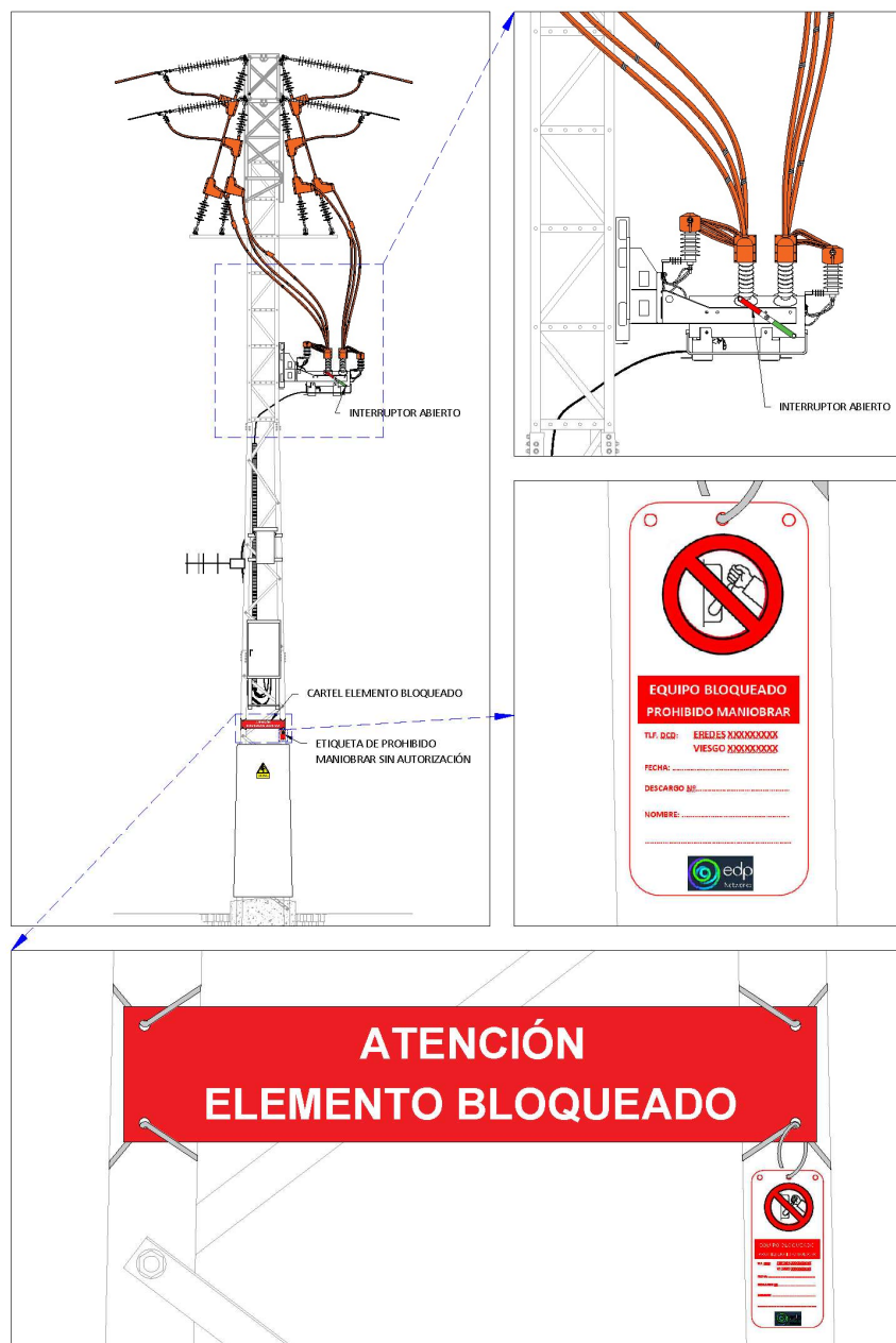
Figura 17: Ejemplo de bloqueo y consignación aplicado a elemento de maniobra tipo IAT o IA2T de interperie en línea MT.
