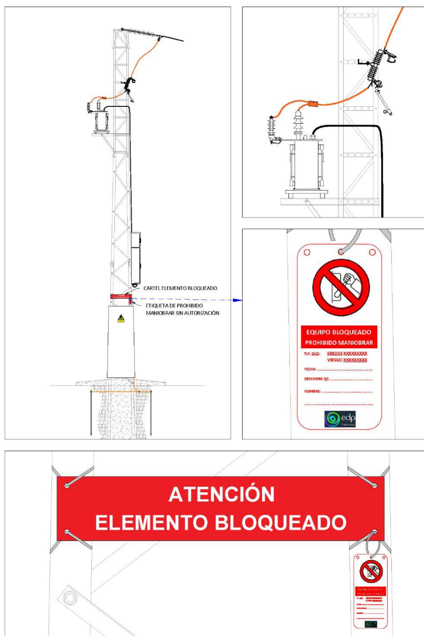
Figura 25: Ejemplo de bloqueo y consignación aplicado únicamente (para descargo) a seccionador fusible XS (maniobrado con pértiga), en un centro de transformación de intemperie.
