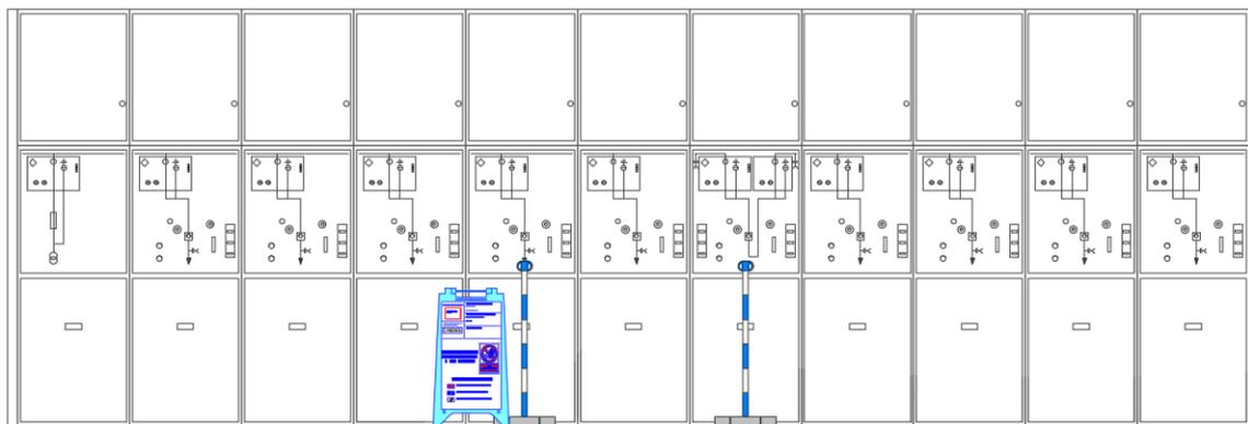
Figura 7: Identificación y delimitación para el acceso a trabajos en celda de media tensión, sin posibilidad de acceso a zonas de tensión o accionamiento involuntario de mecanismos (no incluidas maniobras, ni tierras).
