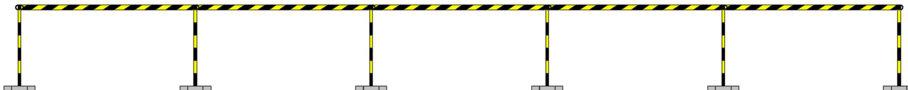
**Figura 5:** Disposición en alzado de delimitación de zona amarilla: zona con riesgos y zona de acopio.
